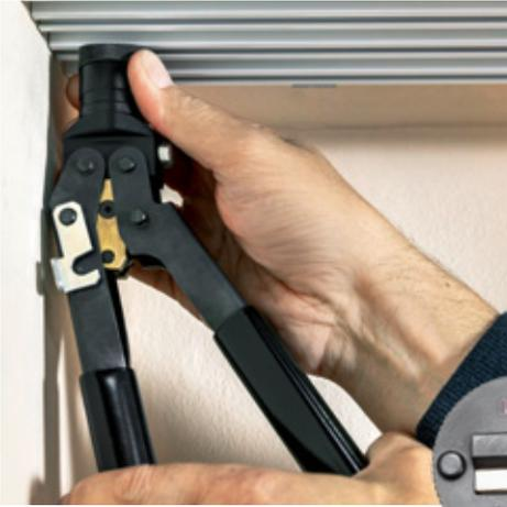
Mit der Ausklinkzange 'CLIC RELEASE' und halben Stanzköpfen lassen sich vor Ort auch im Nachhinein noch problemlos Stanzungen in montierten Schienen durchführen.
