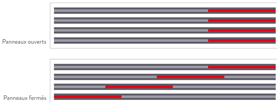
Système de panneaux japonais empilables; positionnement en diagonale des chariots sur un rail à 2 voies. Entraînement des panneaux avec chaîne à boules.
